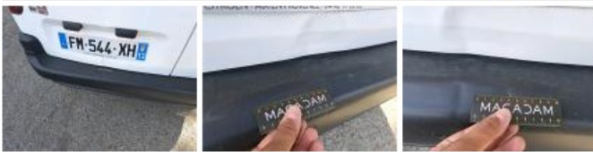
Pare-chocs AR, Déformé / Forcé, E - Remplacer
