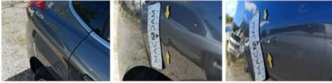
Aile AVD, Bosse(s), LI - Réparer et peindre (complet)
