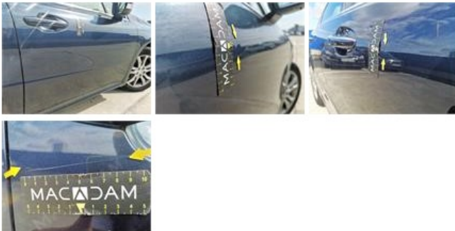
Porte ARD, Bosse(s) et griffe(s), LI - Réparer et peindre (complet)
