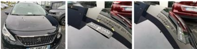
Pavillon, Grêlé, LI - Réparer et peindre (complet)
