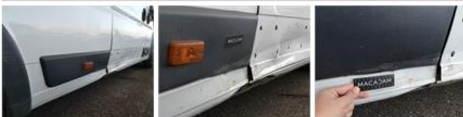
Porte coulissante G, Bosse(s) et griffe(s), Le - Remplacer et peindre
