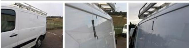
Porte de malle AR G, Bosse(s), Le - Remplacer et peindre
