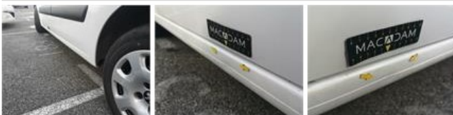
Porte de malle AR G, Mauvaise réparation, Peindre
