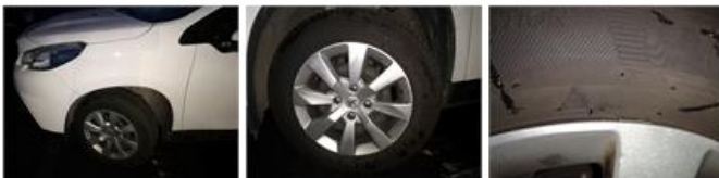
Pneu AVG, Hors tolérance, E - Remplacer
