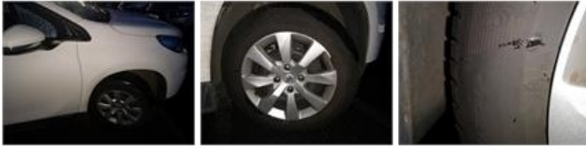
Pneu AVD, Hors tolérance, E - Remplacer
