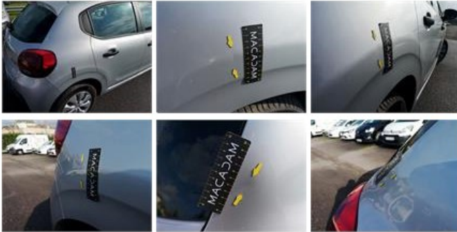
Porte ARD, Bosse(s), LI - Réparer et peindre (complet)
