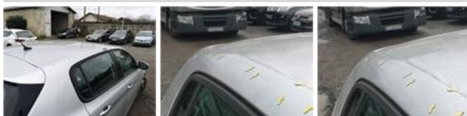
Montant de toit D, Grêlé, LI - Réparer et peindre (complet)
