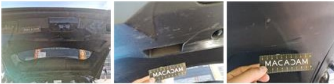
Pare-chocs AR, Mauvaise réparation, Peindre
