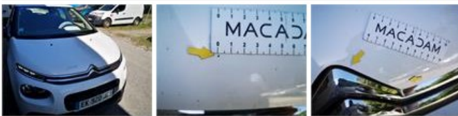
Porte AVG, Mauvaise réparation, Peindre
