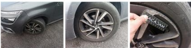
Pneu AVD, Déchirure, E - Remplacer
