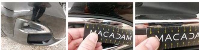
Moulure de pare-chocs AVD, Cassé, E - Remplacer
