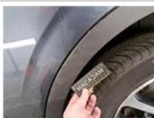
Pare-chocs AR, Déformé / Forcé, E - Remplacer
