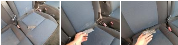
Revêtement assise ARD, Déchirure, Smart repair +
