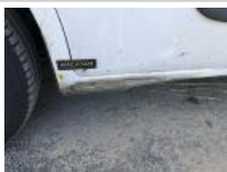
Panneau ARG, Bosse(s) et griffe(s), LI - Réparer et peindre (complet)
