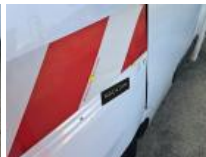
Aile AVG, Bosse(s), Le - Remplacer et peindre
