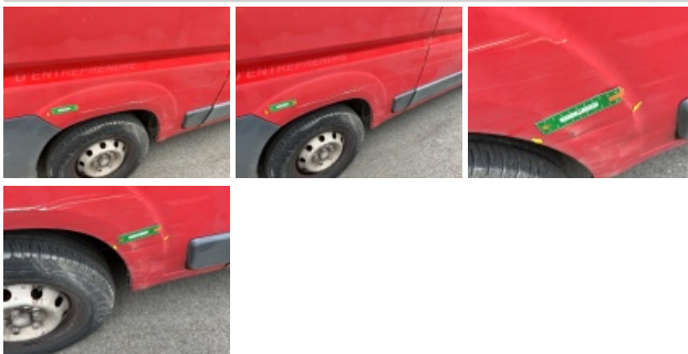
Moulure de coffre, Dégrafé, N - Dépose/Répose
