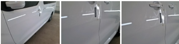
Porte coulissante G, Mauvaise réparation, Peindre
