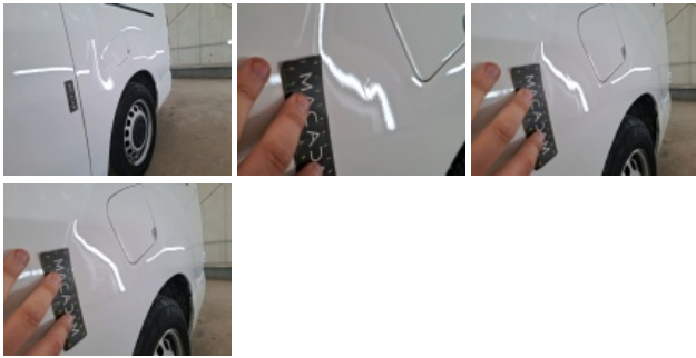
Panneau ARD, Mauvaise réparation, Peindre
