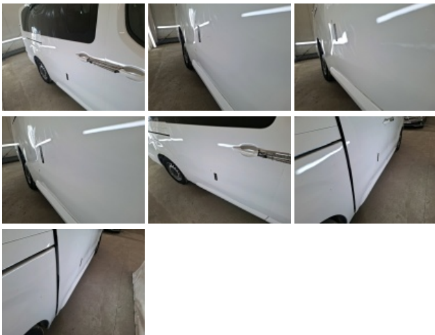
Poignée ext porte ARD, Cassé, Le - Remplacer et peindre
