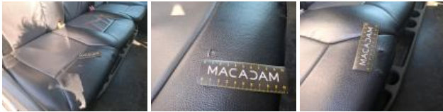
Revêtement assise ARG, Déchirure, Réparer/rempl. (montant forfaitaire)
