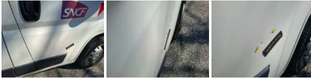
Porte coulissante D, Bosse(s) et griffe(s), LI - Réparer et peindre (complet)
