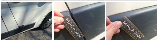
Moulure porte AVD, Griffe(s), Réparer/rempl. (montant forfaitaire)
