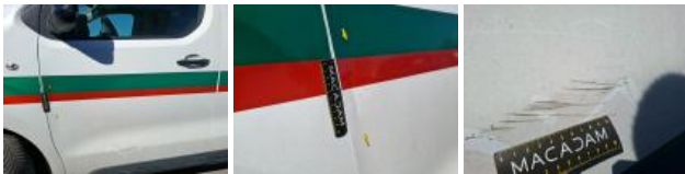
Moulure porte AVG, Griffé(s), E - Remplacer
