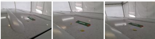
Pavillon caisse, Bosse(s), PDR - Débosselage ss peinture
