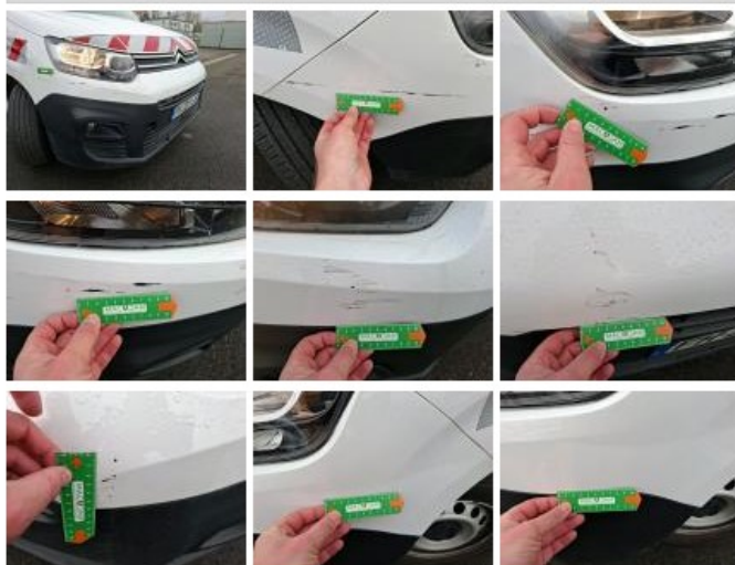
Pare-chocs AV, Cassé, E - Remplacer
