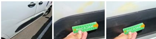
Porte coulissante D, Différence de teinte, Peindre
