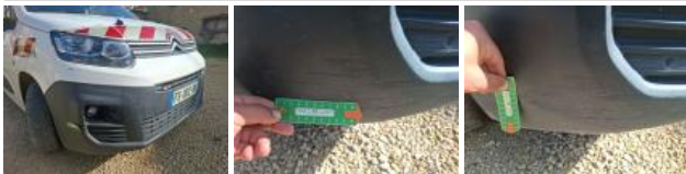
Moulure de pare-chocs AVD, Manque, E - Remplacer
