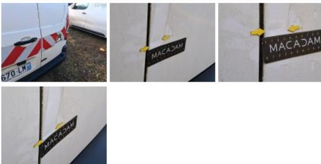
Coin pare-chocs ARG, Déformé / Forcé, E - Remplacer
