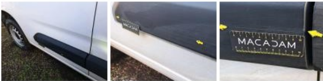
Moulure porte AVD, Griffe(s), E - Remplacer
