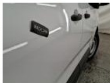
Porte coulissante D, Mauvaise réparation, Peindre
