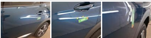
Porte ARD, Mauvaise réparation, Peindre
