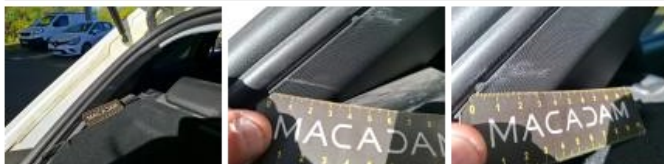
Butée cache-bagage, Manque, E - Remplacer
