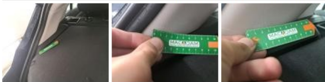
Joint de coffre, Déchirure, E - Remplacer
