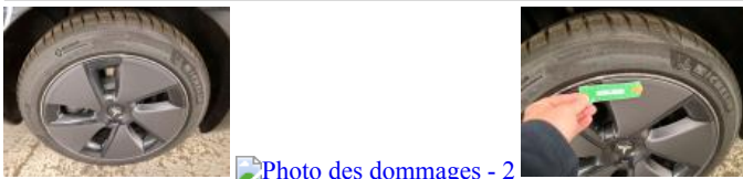
Jante alum. AVD, Déformé / Forcé, E - Remplacer
