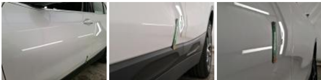
Porte ARD, Mauvaise réparation, Peindre
